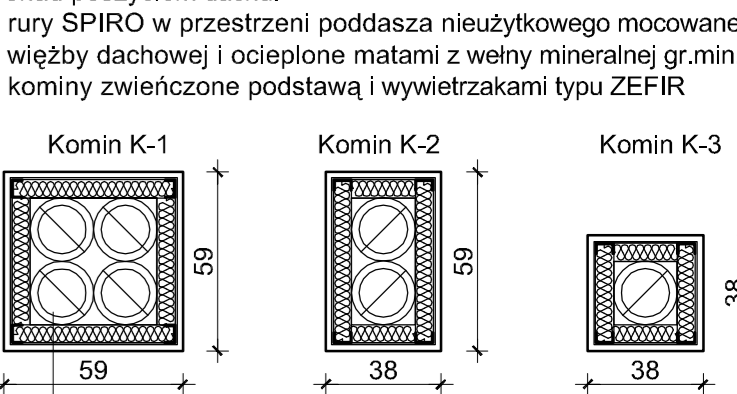
DETAL KOMINA W KONSTRUKCJI SZKIELETOWEJ PONAD DACHEM Rozwiązanie przedstawione na rysunku powyżej dotyczy kominów ponad poszyciem dachu. - rury SPIRO w przestrzeni poddasza nieużytkowego mocowane do więźby dachowej i ocieplone matami z wełny mineralnej gr.min.5cm - kominy zwieńczone podstawą i wentryzakami typu ZEFIR
